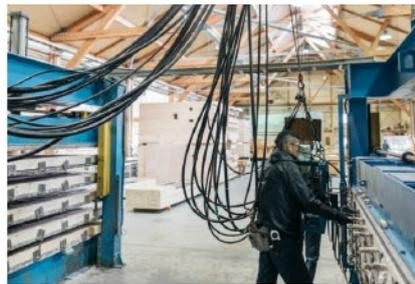
断熱パネルは一定の**温度管理された工場**で高圧プレスを加えることで密度の高い**均一な製品**が保たれています。また**防火構造試験（30分耐火）**を通じて国土交通大臣の防火構造認定を取得しています。
