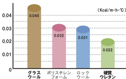
炭化コルクと硬質ウレタンフォームを一体化した複合断熱パネルは、**防音性と吸音性**を兼ね備えるほか、一般的に使用される**グラスウールの2倍**の断熱性能を持ちます。
